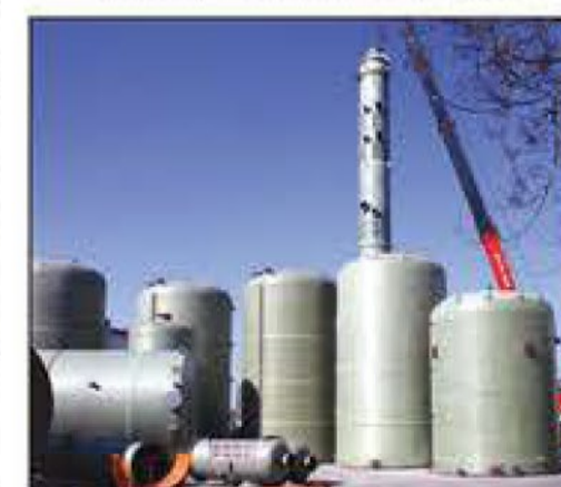
玻璃钢洗涤塔 FRP scrubber
