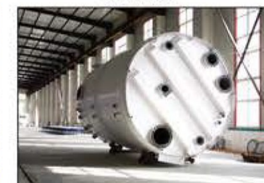
玻璃钢罐 FRP tank
