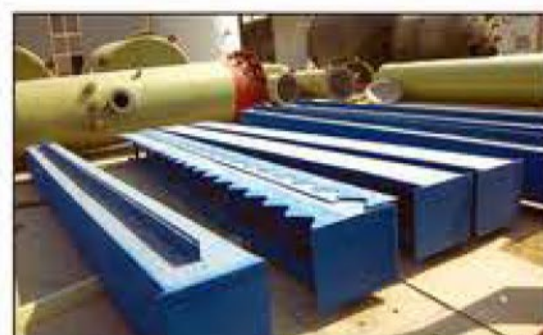
玻璃钢围堰 FRP weir
